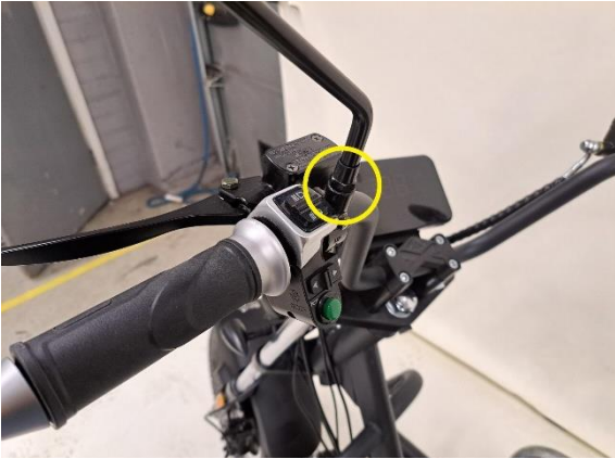
Löysää vasemman peilin lukitusmutteria (kiintoavain 14 mm).
