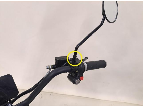
Löysää oikean peilin lukitusmutteria (kiintoavain 14 mm).
